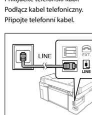
Поврзување со PSTN или PBX. Povezivanje sa PSTN-om ili PBX-om. Podłączanie do linii PSTN lub centrali PBX. Pripojování k PSTN nebo PBX.
